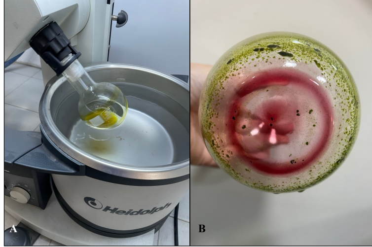
Şekil 3. 2: A, B: Bitkisel ekstraktların evaporatörde solventlerin uçurularak elde edilmesi
